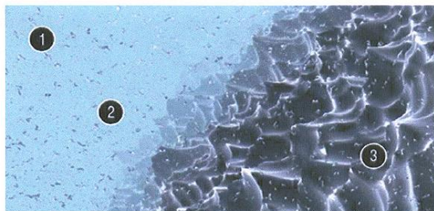
Abb.1 Nanopartikelare, hochkristalline Kalziumphosphatteilchen in einer kolloidalen Lösung [1] heften sich auf der mikrostrukturierten OSSEOTITE Oberfläche [3] selbst an. Der Anlagerungsmechanismus erfolgt über Selbstorganisationsprozesse [2] (ionale, molekulare und thermodynamische Wechselwirkungen) mit der Oberfläche.
